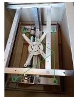
El montaje del proyector debe hacerlo hasta que ya esté instalado el Skydoor® (página [6](#))
