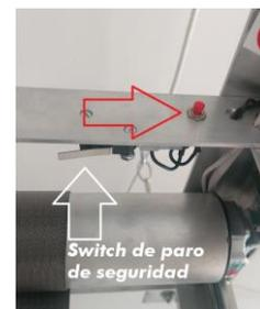
**Recuerde que nada debe impedir el paso del soporte, de ser así el motor acabará dañándose y se invalida la garantía.**
